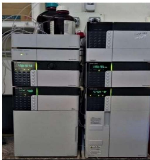
**Figure 29:** chromatographe liquide à haute performance (CLHP SHIMADZU SPD-10A).
