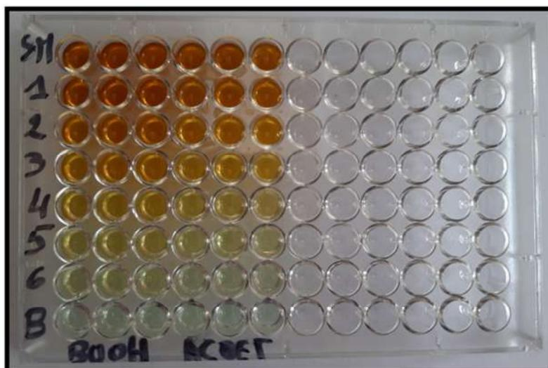
**Figure 47:** Résultats du test de CUPRAC sur microplaques
